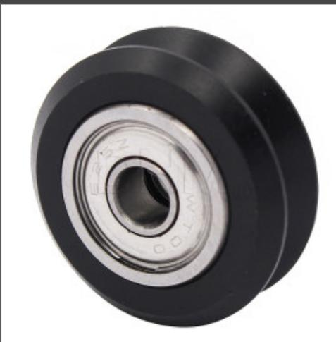
Contenido: 1 rueda Delrin Big W 625ZZ Rueda de Delrin ideal para utilizar con perfiles de aluminio en la manipulación de la impresora 3D, pero también en otros proyectos. Permite el mecanizado con alta precisión y tolerancia. Apto para perfiles de 20x20. Agujero interno de 5 mm. Rodamiento 625zz.
